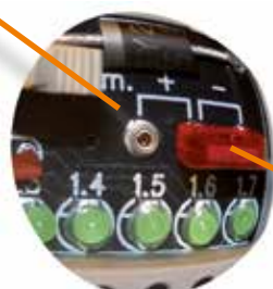
LED de visualisation pour chaque voie. Switch pour câblage NPN ou PNP.
