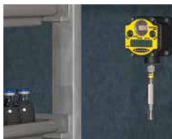
Capteur de température et d'humidité
