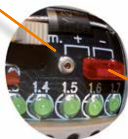
LED de visualisation pour chaque voie. Switch pour câblage NPN ou PNP.
