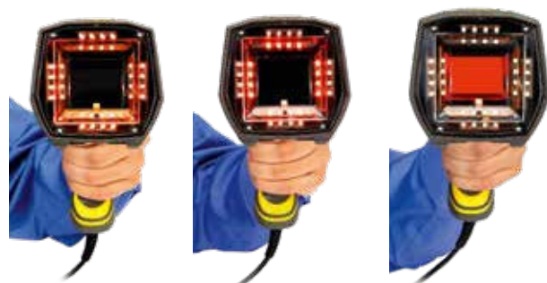
Éclairage à 30, 45 à 90°
