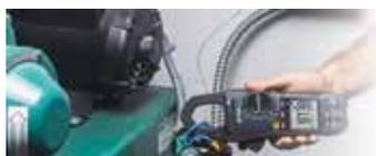
**Mesure VFD :** Mesure de tensions ou de courants AC sur les moteurs commandés par des variateurs de fréquence et les systèmes alimentés par des onduleurs. Ce mode est aussi appelé VFC, LPF ou "filtre passe-bas" selon les fabricants.
